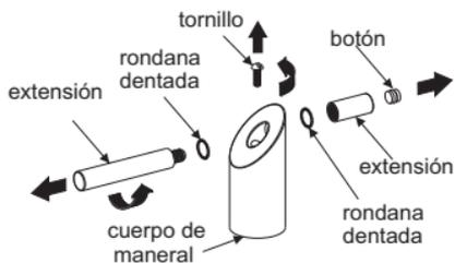
2 Coloque la base con o'ring en el cuerpo del maneral e inserte en el cuerpo de empotrar y apriete firmemente el tornillo.
